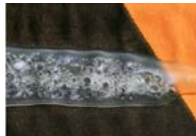
Burbujas en la fusión en caliente en sustratos
