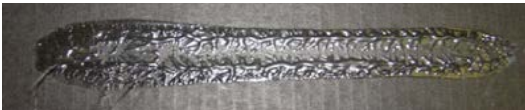
Unión interrumpida / se abre mientras todavía es un líquido caliente
